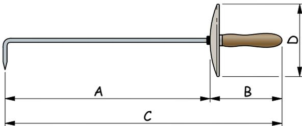
Haken aus elektroverzinktem Stahl, mit Bichromatbelag, Länge 180 bis 1000 mm.
