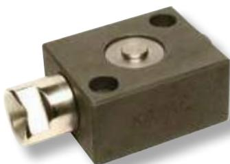
Support unter das Werkstück setzen und Bedienwelle drehen bis der Kontakt hergestellt ist
