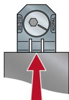
**Einfacher Anschlag** (1 starrer Anschlag) benötigt 2 Anschläge um ein Teil längs einer Geraden zu positionieren.
