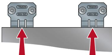
**Doppelter Anschlag** (2 starre Anschläge) Anschlag genügt um ein Teil längs einer Geraden zu positionieren
