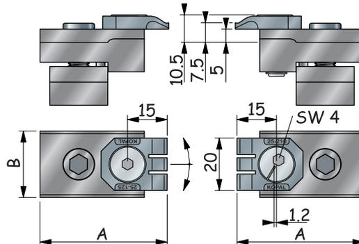
Werkstück direkt auf der Tischfläche gespannt, oder gestützt auf Unterleger (für frei nach unten auslaufende Bearbeitung)
