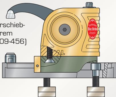
Position des Nutensteins des Spanners oder des Unterbaus gemäß Höhe der Nut mit minimalstem Spiel justieren
