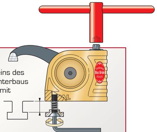
Vergrößerung der Spannweite um 90 mm mit dem extralangen Spannarm (05-140)
